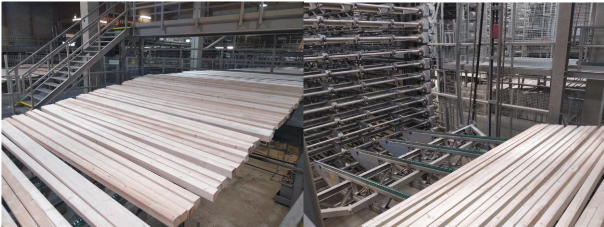
Figuur 13 transportatie van houten balken over verschillende lopende banden
