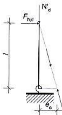
Figuur 10 — Schematisering ingeklemde wand
